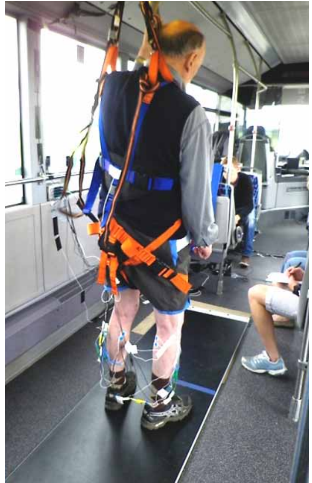
Anordnung zur Messung der zum Stehen in einem fahrenden oder bremsenden Bus erforderlichen Kräfte.
