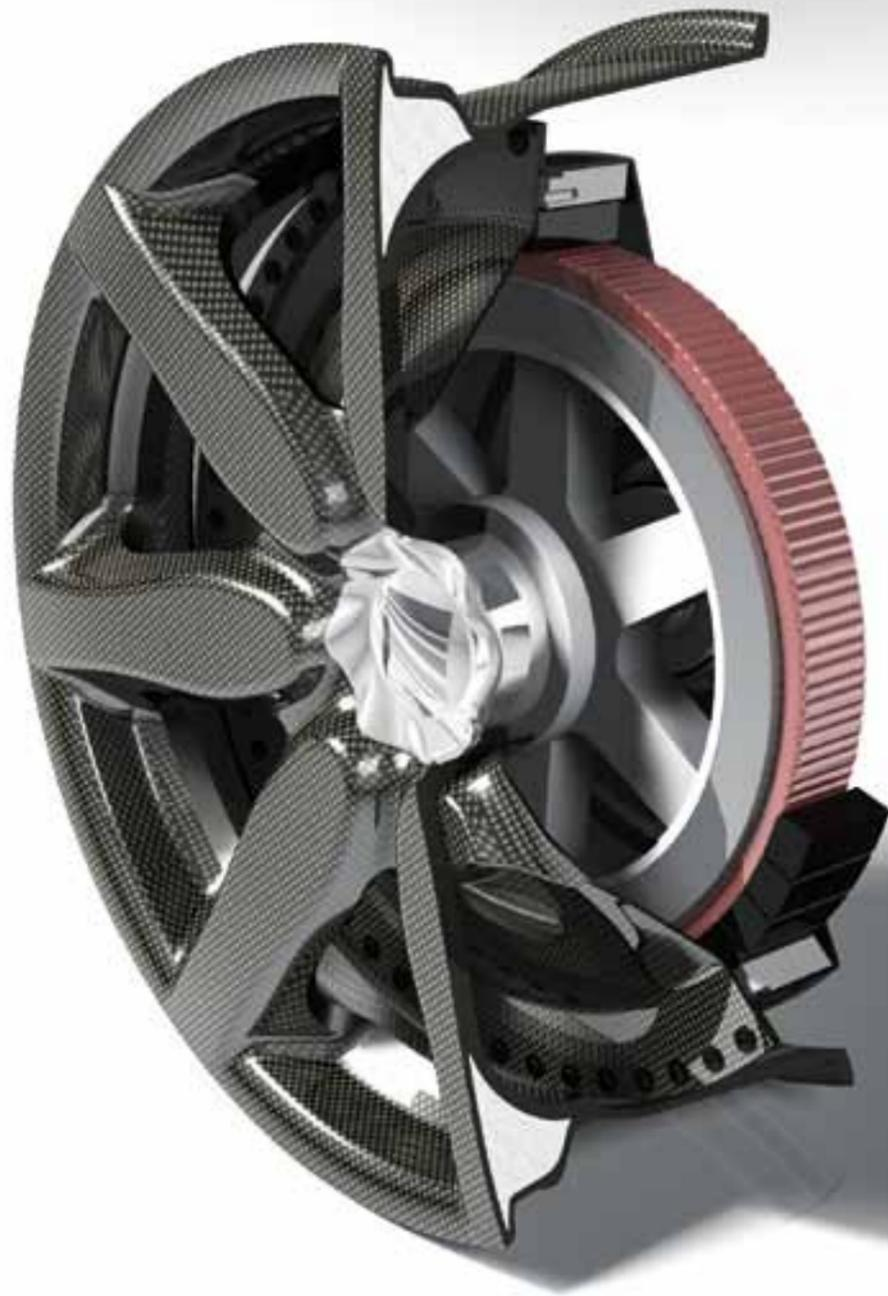
CFK-Rad mit integriertem Rad-Naben-Motor
