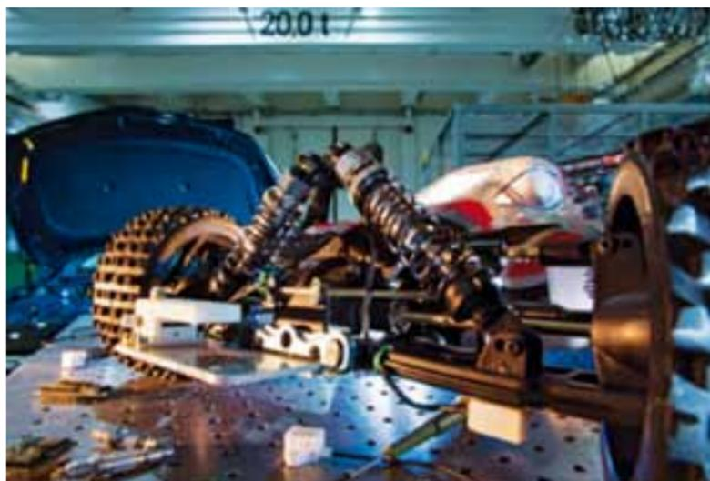
Überwachung von Stoßdämpfern mittels intelligenter Sensorknoten.
