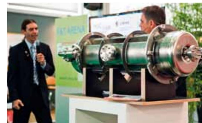
Supraleitender Resonator zur effizienten Beschleunigung von Protonen und Ionen.
