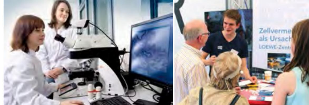
**Bild 1:** Mitarbeiterinnen am Laser-Mikrodissektions-Gerät. Mit diesem Mikroskop können gezielt Gewebe wie z. B. Gefäße aus mikroskopischen Präparaten zur weiteren Analyse ausgeschnitten werden, das ist besonders wichtig für Untersuchungen an Lungengewebe, das aus verschiedenen Gewebstypen zusammengesetzt ist.
