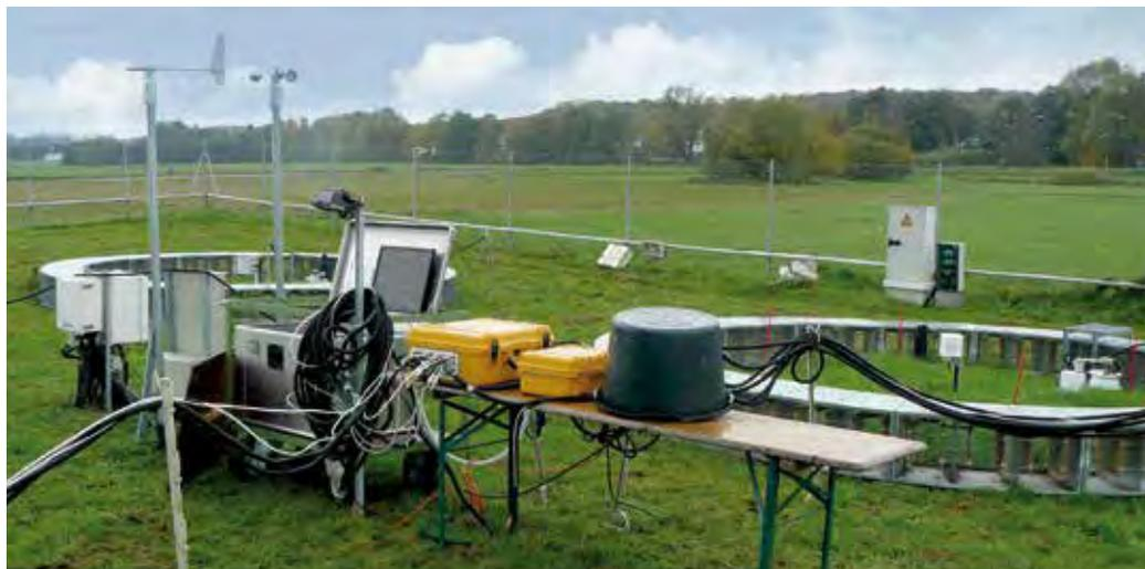
**Bild 1:** Einsatz eines automatischen Messsystems im Gießen T-FACE zur gleichzeitigen, zeitlich hochauflösenden Ermittlung der Treibhausgasflüsse von CO<sub>2</sub>, CH<sub>4</sub> und N<sub>2</sub>O (20.10.2017).
