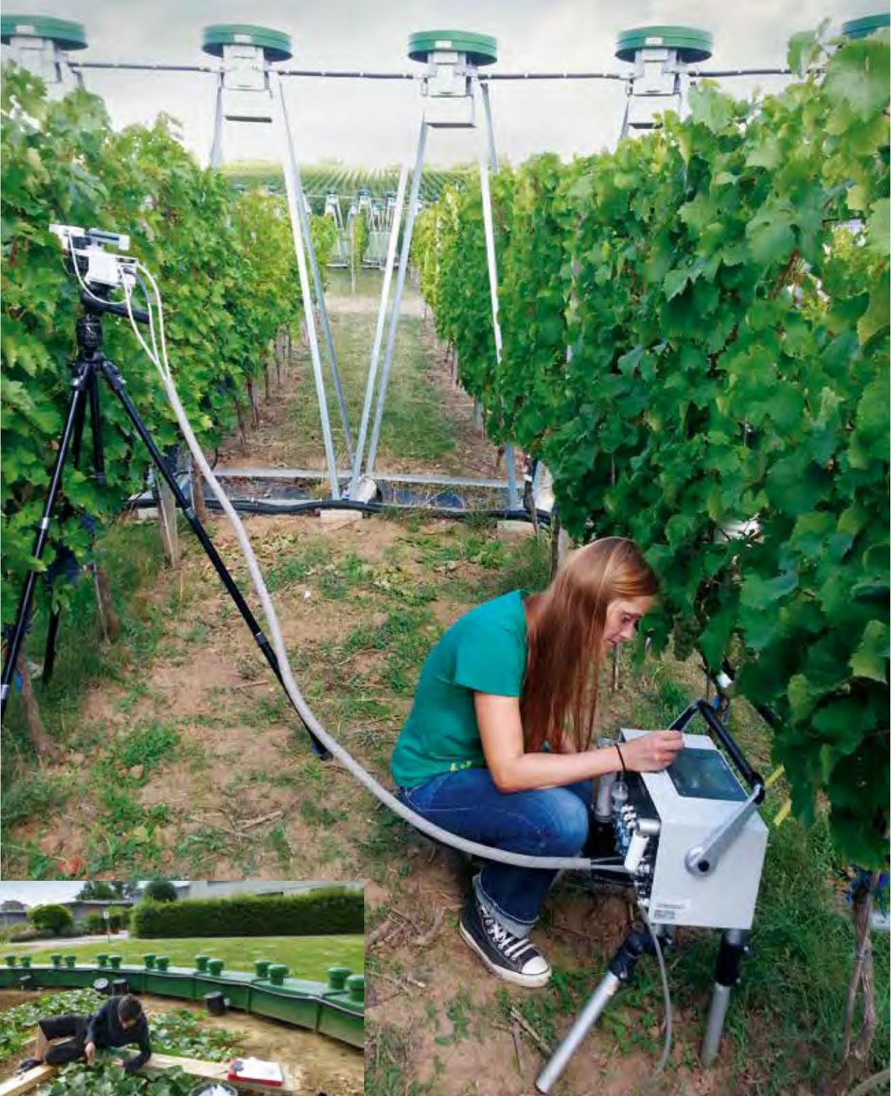
**Bild 2:** Gaswechselformung an *Vitis vinifera* L. cv. Riesling in einem FACE-Ring. Abgebildet ist M. Sc. Yvette Wohlfahrt bei der Messung.
