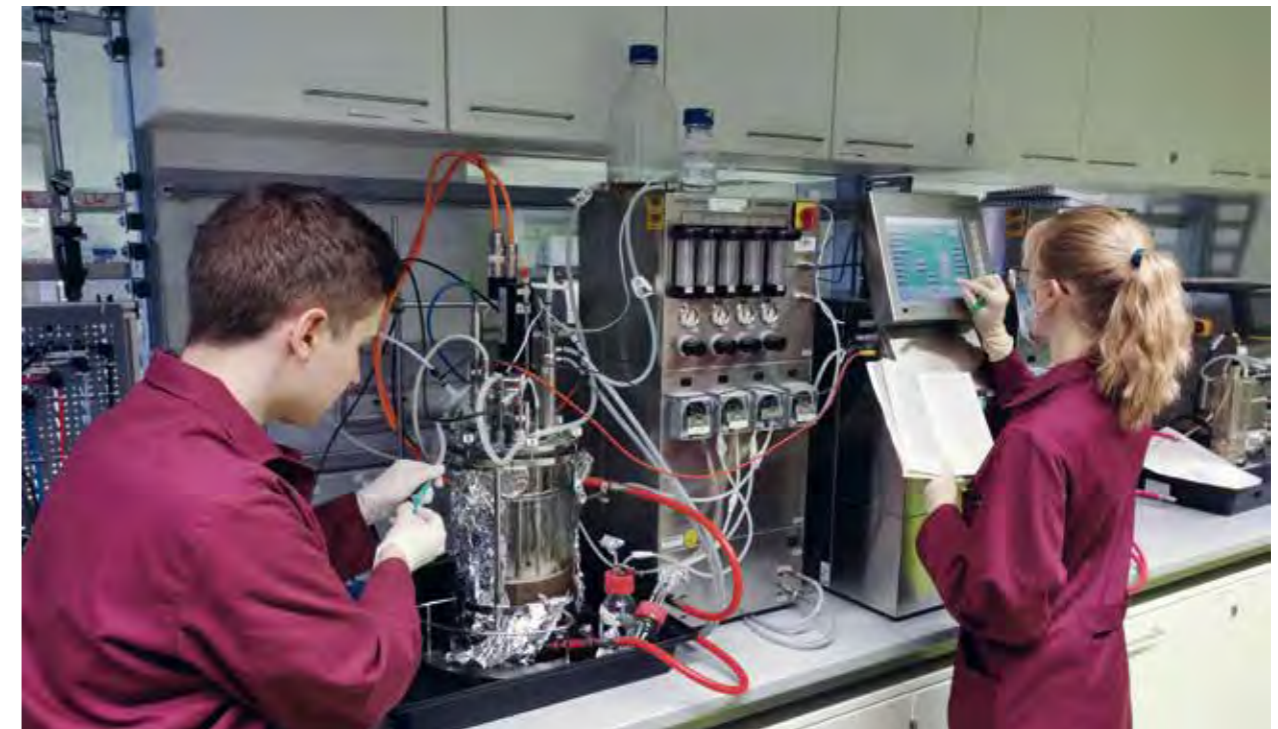
Bild 2: Kultivierung von Sf-9 Insektenzellen im Bioreaktor in den Laborräumen der THM, Gießen. (© Lukas Käßer)
