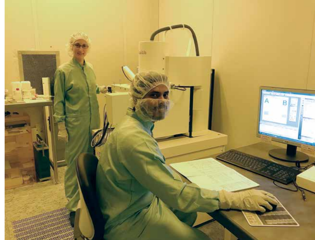
Bild 2: M. Gerstel und M. Shaharukh an der Raith eLine Elektronenstrahl-Lithographie-Anlage. Institut für Nanostrukturtechnologie und Analytik, Universität Kassel. (© Technische Physik, Universität Kassel)
