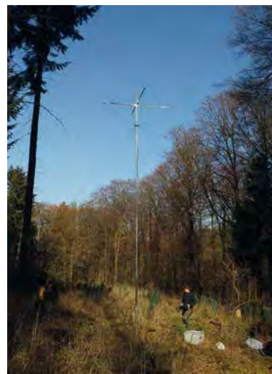
Bild 3: Eine von 15 Antennen des neu entwickelten Systems zur automatisierten Ortung besonderer Tiere im Wald. (© Natur 4.0/Phillip Bengel)
