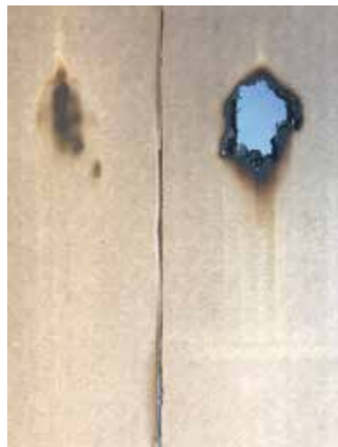
Bild 3: Vergleichende Brandversuche. Bild 4: Papierziegel. (alle: © Dr.-Ing. Heinz-Joachim Schaffrath)
