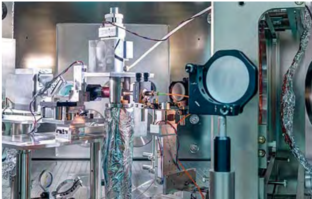
Bild 2: Die Wechselwirkung intensiver Laserstrahlen mit Materie erzeugt Teilchenstrahlen, die für Anwendungen genutzt werden können. (© privat)
