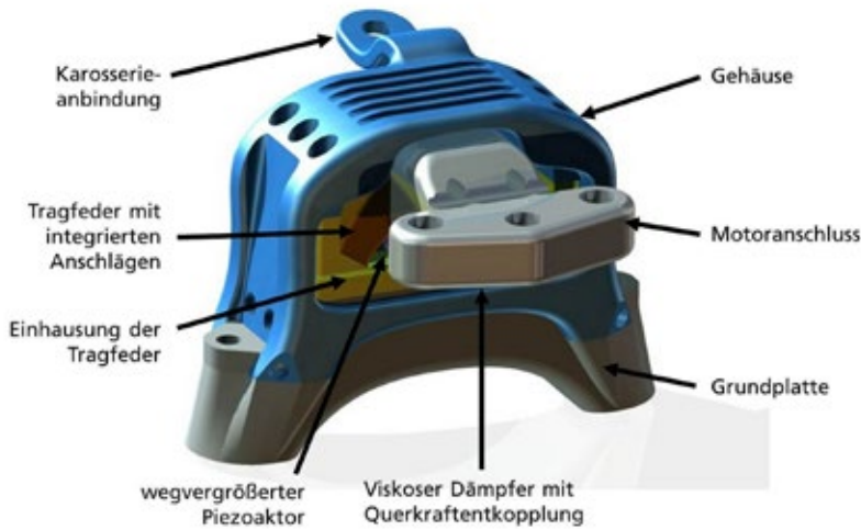
Abbildung 1: Aktives Motorlager; links: Konzept, rechts: eingebaut im Fahrzeug
