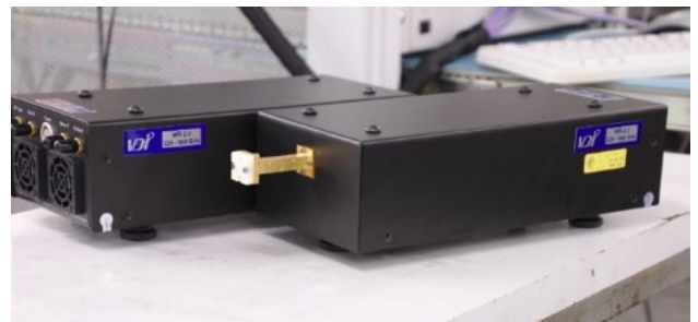
Für das Terahertz-Kompetenzzentrum angeschaffte Quellen für Terahertz-Wellen bis zu 500 GHz. Sie werden für die Entwicklung einer Vielzahl von Komponenten wie Schaltern oder Biosensoren verwendet.
