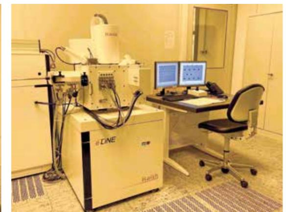
**Bild 3:** Raith eLine Elektronenstrahlithographie-Anlage mit Elektronenstrahlmikroskopieaufnahme der strukturierten Hartmaske. Institut für Nanostrukturtechnologie und Analytik, Universität Kassel. © Technische Physik, Universität Kassel
