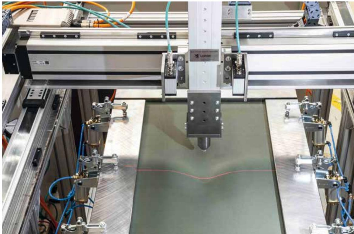
**Bild 2:** Neu entwickelte Anlage zur inkrementellen Umformung von Papier und anderen Fasermaterialien.
