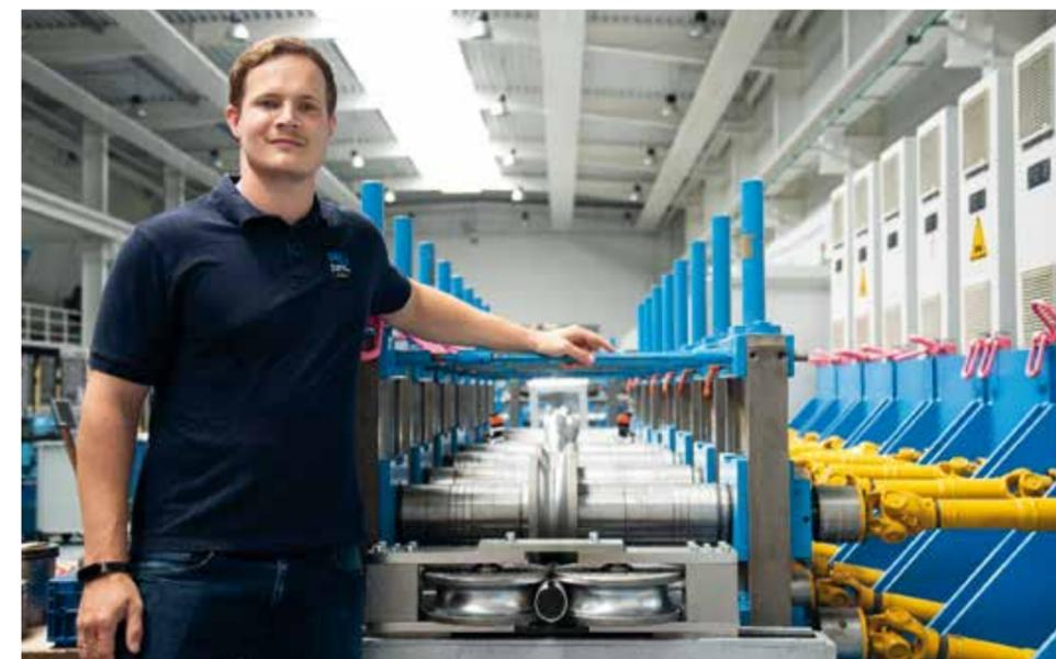
Bild 2: Projektbearbeiter Timon Suckow an der Rollformanlage (Rohreinformung).
