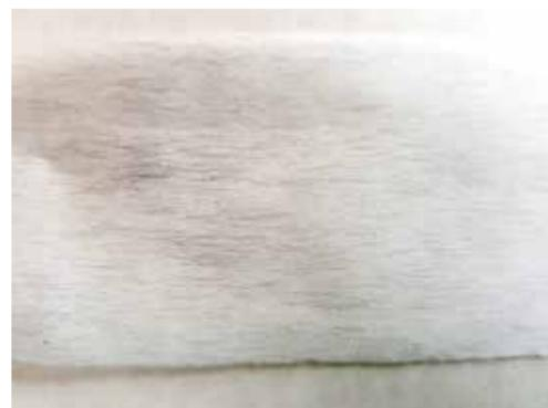
**Bild 3:** Papiervlies mit 1% unidirektional orientierten Carbonfasern.
