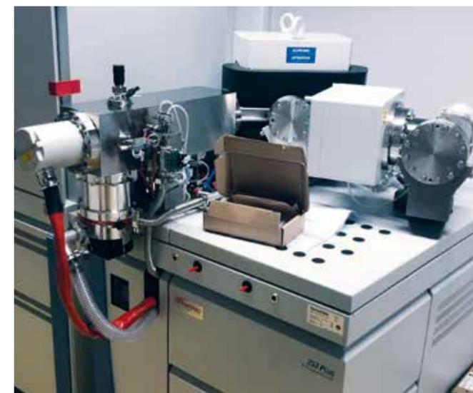
Bild 1: Neues MAT253Plus Massenspektrometer an der Goethe-Universität Frankfurt am Main.
