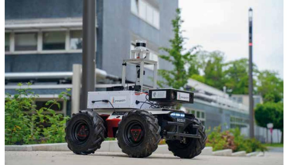
Bild 1: emergenCITY Roboter Scout als mobile Unterstützung in Krisenszenarien. Er ist mit zahlreichen Sensoren und Kameras ausgestattet, um in Krisensituationen einen schnelleren Überblick zu bekommen. (© Tobias Ullrich)
