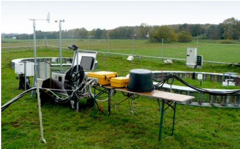
*Einsatz eines automatischen Messsystems im Giessen T-FACE zur gleichzeitigen zeitlich hochaufgelösten Ermittlung der Treibhausgasflüsse von CO<sub>2</sub>, CH<sub>4</sub> und N<sub>2</sub>O (20.10.2017).*
