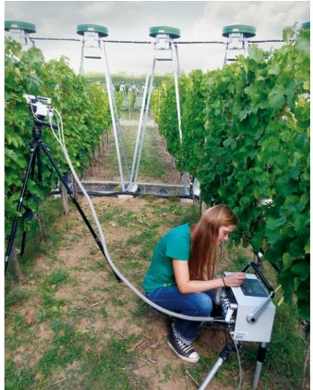
Gaswechselformung an *Vitis vinifera* L. cv. Riesling in einem FACE-Ring. Abgebildet ist M. Sc. Yvette Wohlfahrt bei der Messung.
