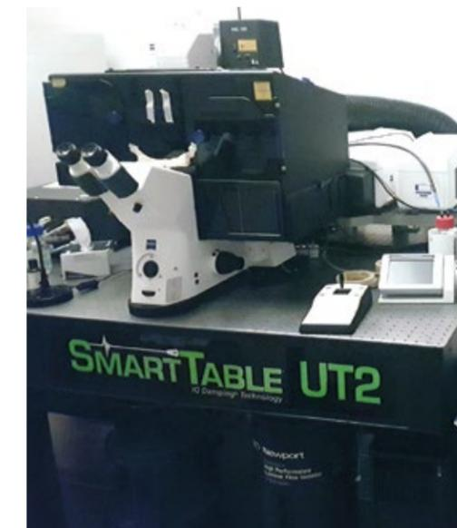
**Bild 3:** Konfokales Laser Scanning Fluoreszenz Mikroskop LSM 880 von Zeiss mit zusätzlich ausgestatteten Zwei-Photonen Laser. Dieses Mikroskop dient Heike Krüger zum einen dazu, funktionalisierte 2D- und 3D-Oberflächen gezielt zu aktivieren und zum anderen in den aktivierten Bereichen immobilisierte Proteine und Peptide über deren Fluoreszenz-Signal zu visualisieren. © Heike Krüger, Goethe-Universität Frankfurt am Main
