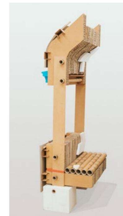
Bild 2: Idealisierendes Schnittmodell der Detailstruktur der Trauf- und Sockelzone eines Gebäudes aus Papier. © FG Plastisches Gestalten, TUD; Foto: Oskar Gerspach-Wolf
