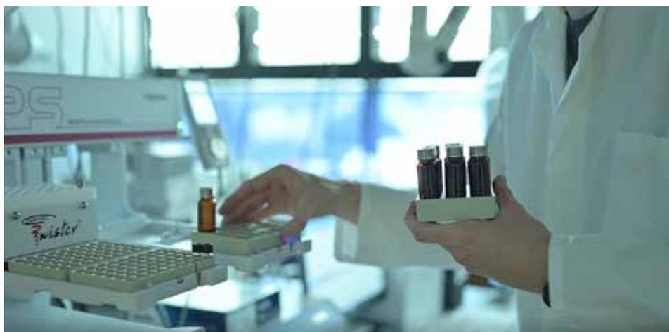
**Bild 1:** Doktorand der HGU während der Messung von Thiolen mittels GC-MS.
