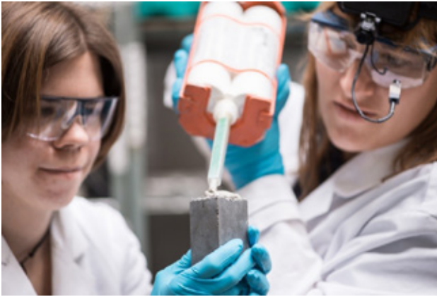
Beim manuellen Kleben einer Probe aus ultrahochfestem Beton (UHPC) ist Präzision gefragt. Mit der Blickfelderfassung ist eine simultane Qualitätskontrolle möglich.
