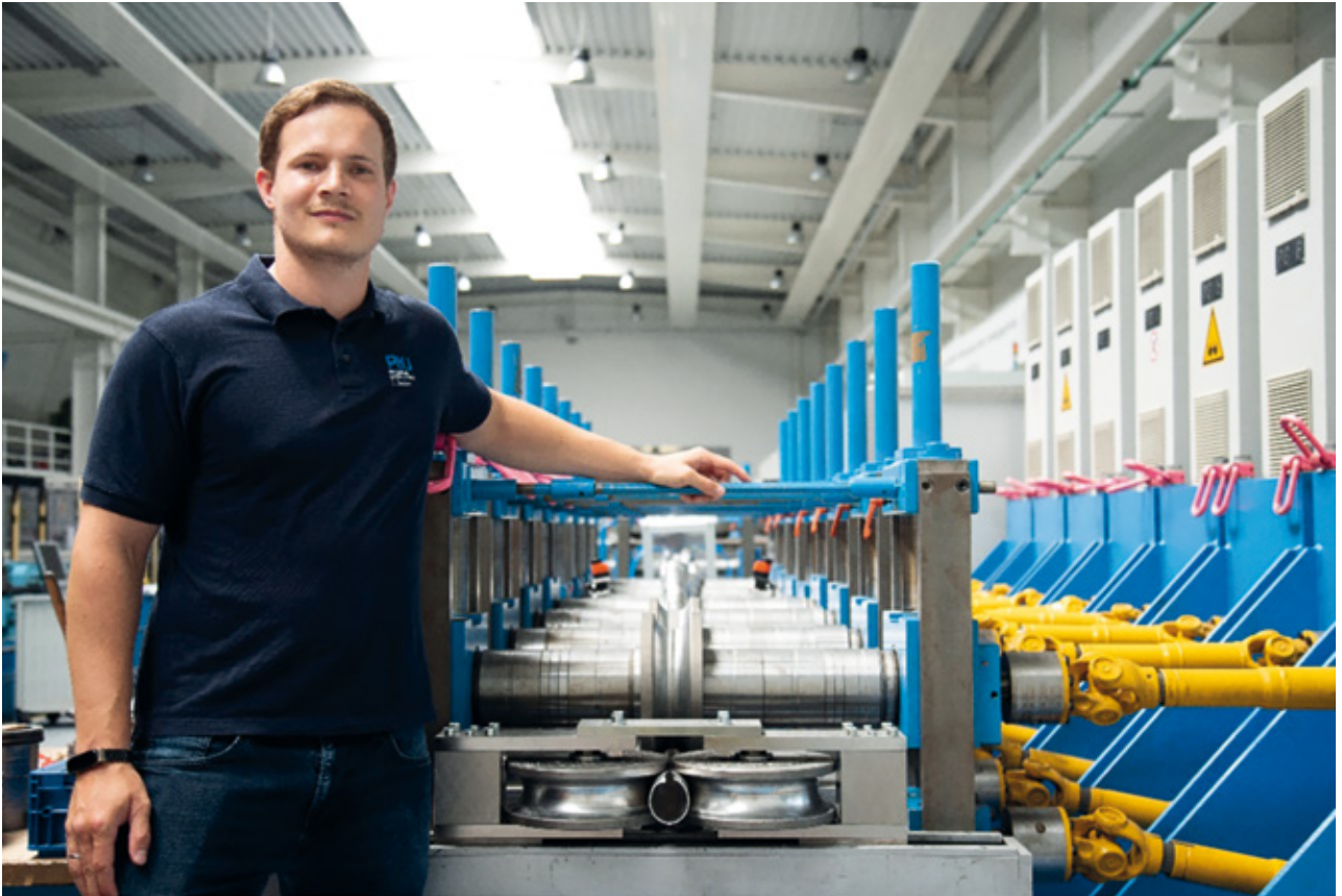
Projektbearbeiter Timon Suckow an der Rollformanlage (Rohreinformung).
