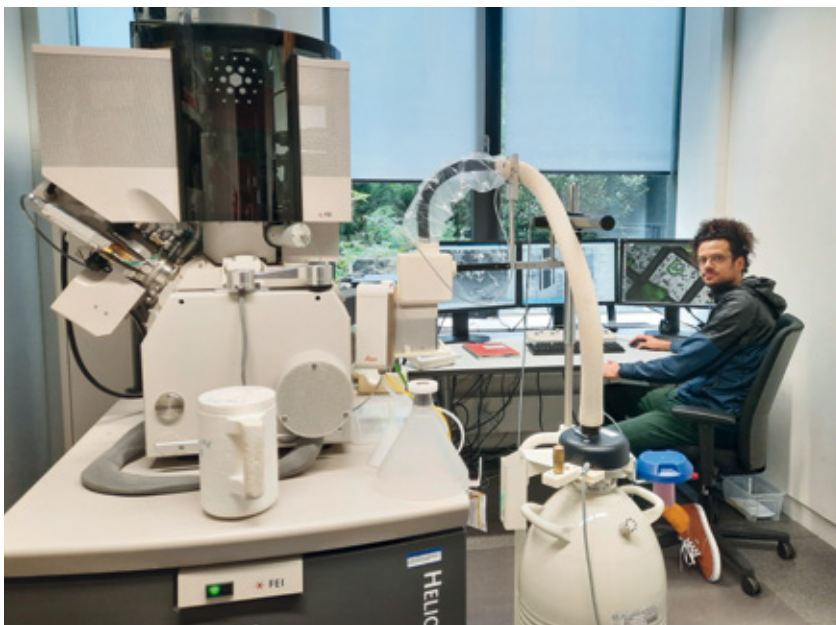
Konstantin Grohmann an einem Cryo-Zweistrahler-Rasterelektronenmikroskop zur Betrachtung einer nativ eingefrorenen Probe. Mittels fokussiertem Ionenstrahl lässt sich die Probe zu einer 200 nm-dünnen, und somit Elektronen-transparenten, Lamelle schneiden, welche im Anschluss am Cryo-Transmissions-Elektronenmikroskop tomographisch untersucht werden kann. Ziel ist die detaillierte Untersuchung und strukturelle Charakterisierung von Zell-Zell-Kontakten.
