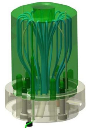
**Bild 1:** Additives Bauteil: CAD-Zeichnung des Werkzeugstempels mit konturnaher Kühlung, © Werner Schmid GmbH
