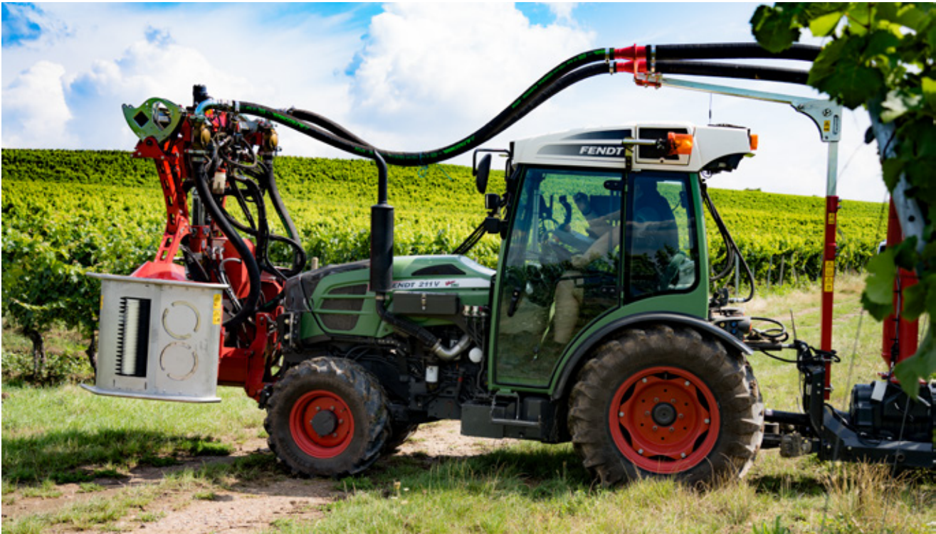
Bild 1: VITipulse Combi von ERO – spezifisches doppelseitiges Entlaubungsgerät. © HGU/ Johannes Wendel
