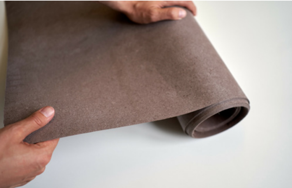
Das Foto zeigt LOVR™ als Rollenmaterial, das im kontinuierlichen Verfahren produziert wurde. © Revoltech GmbH
