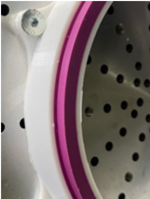
Detail einer Multimaterial-Dichtung, zur Nachbearbeitung eingespannt in einer Drehmaschine. © Kudernak GmbH
