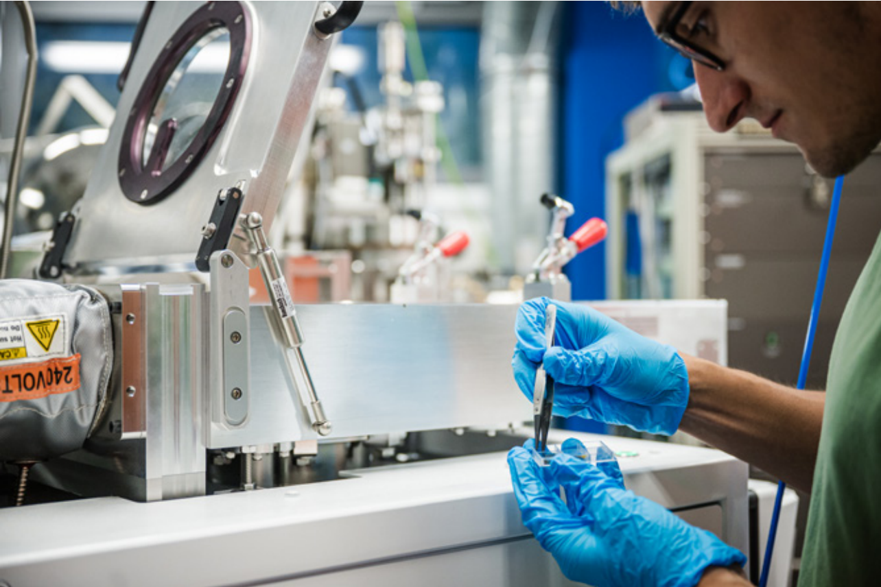
Bild 1: Probenbeladung des Loadlock der Atomlagenabscheidung (ALD) an einer Anlage/Core Facility im Dünnschicht- und Epitaxielabor (DünE) des Zentrums für Materialforschung (ZfM) an der JLU. © JLU/Katrina Friese
