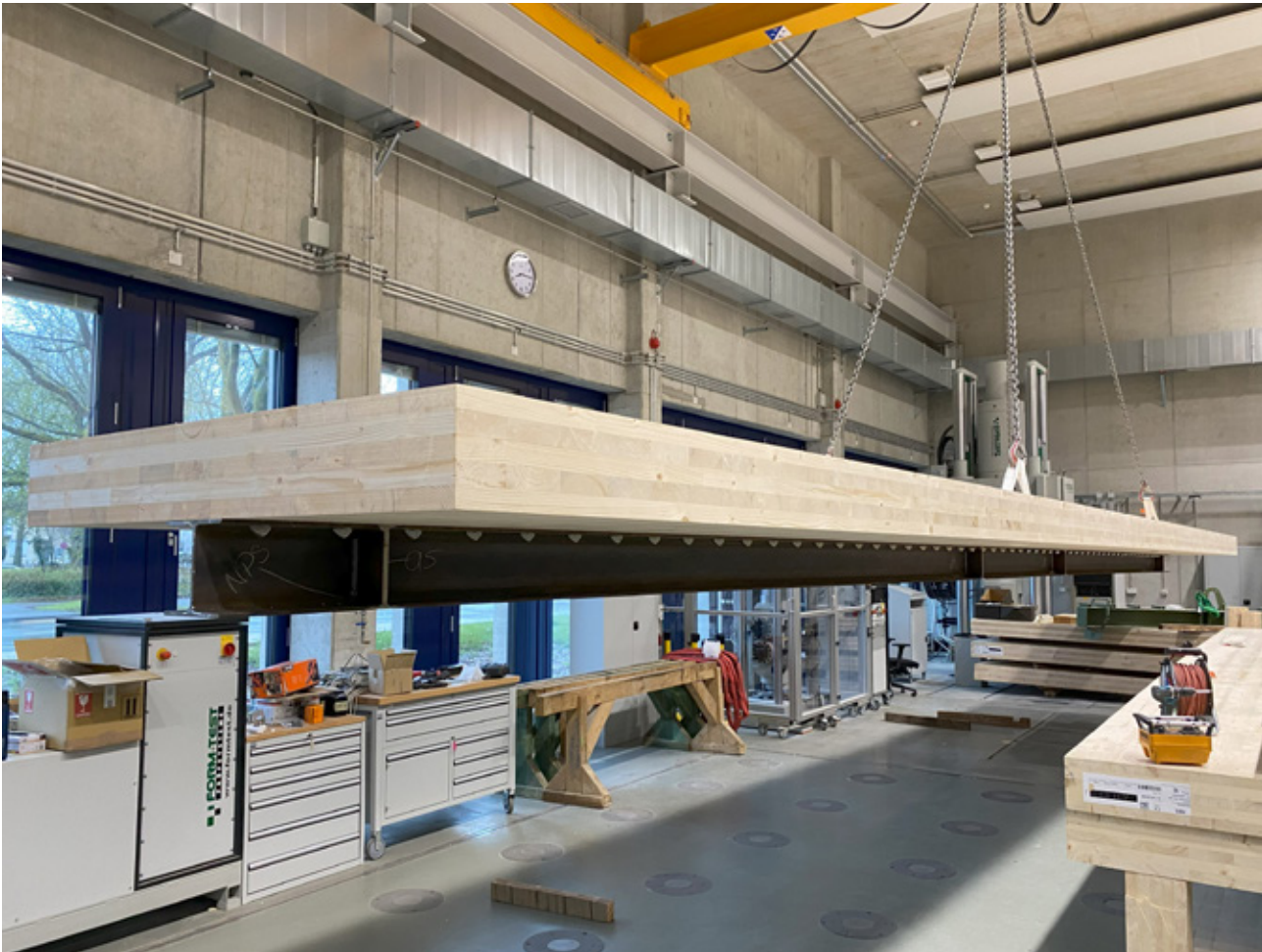
HA-Projekt-Nr. 1283/21-184: Brettsperrholz-Stahl-Verbundträger – Entwicklung und Untersuchung eines hybriden Tragwerks aus Brettsperrholz im Verbund mit Stahlträgern Verbundträger aus Brettsperrholz und Stahl nach dem Zusammenbau. © THM
