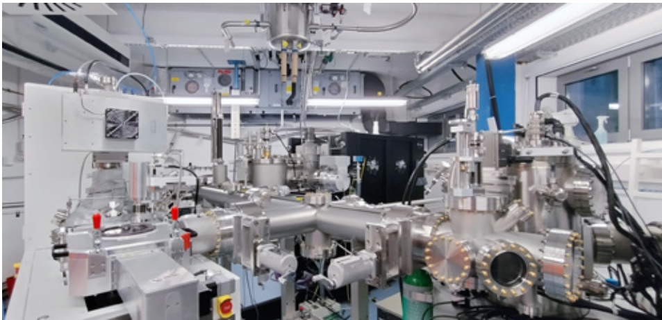
Bild 2: Ultrahochvakuum-Cluster-tool zur Molekularstrahlepitaxie, Atomlagenabscheidung (ALD) und Diagnostik mittels Röntgen-Photo-emissionsspektroskopie im Dünnschicht- und Epitaxielabor (DünE) des Zentrums für Materialforschung (ZfM) an der JLU. © JLU/Sangam Chatterjee
