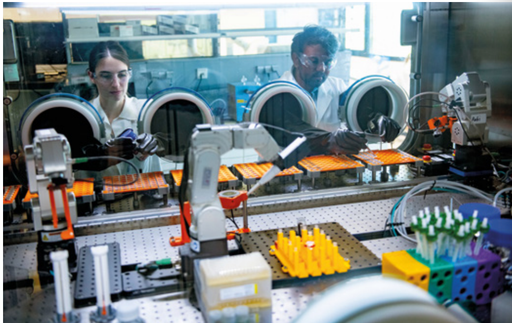
POLiS: An einer Vakuum-Handschuhbox werden Knopfzellen zusammengesetzt, um sie später zu testen. In dieser teilautomatisierten Box übernehmen Roboter fast alle Aufgaben.
